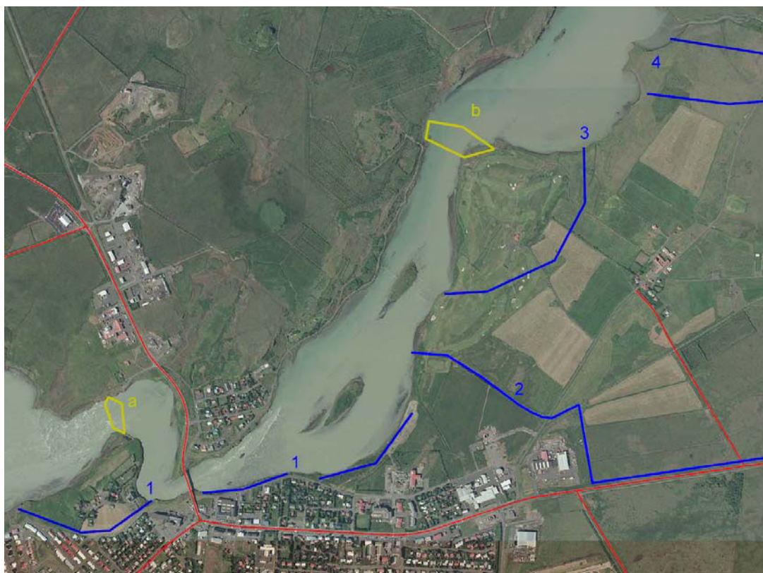
Mynd 2. Myndin sýnir flóðahættu úr Ölfusá í nágrenni Selfoss eins og staðan er í dag. Staðsetningar a og b (afmarkað með gulu í Ölfusá) sýna hvar ísstíflur og klakahröngl hefur náð að myndast. Við klakamyndun neðan brúar ( staðsetning a) hefur myndast bakflæði og flætt inn í bæinn. (blár línur merktar 1). Ekki hafa oft myndast klakastíflur við gamla ferjulagið (staðsetning b) en þó eru til lýsingar um slíkt frá 19 öld. Ef slík klakastífla myndaðist er líklegt að vatn myndi finna sé farveg austan við Svarfhól og renna aftur í Ölfusá sunnan við eða yfir syðri hluta golfvallar. Athuga ber að flóðaleiðir eru settir inn samkvæmt grófu mati og ætti ekki að líta á sem nákvæmt hættusvæði, heldur sem gróft og leiðbeinandi kort.
